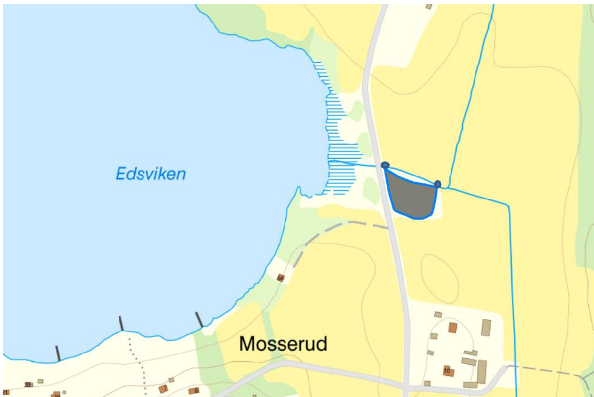
Bild 3. Förslag på ungefärlig utformning av planerad våtmark med in- och utlopp markerade.
