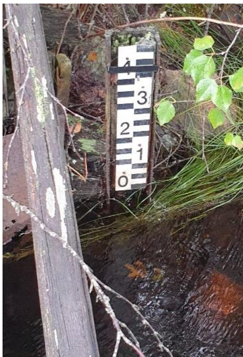
Pegeln visar nivå något under 1 m över tröskeln, aug 2023 om pegel sitter rätt visas DG på 1,40.
