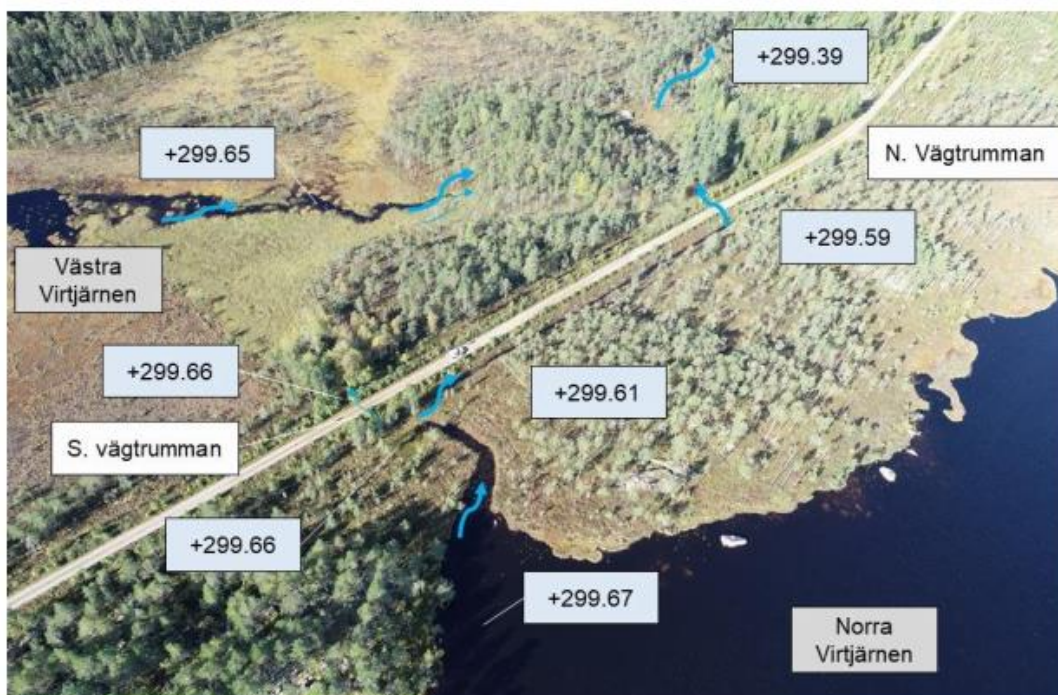
Figur 2. N. Virtjärns utlopp sett från öster. Inmätta vattennivåer och observerade flödesvägar markerade. Norconsult 2019-09-18.
